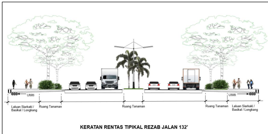
Rajah 22 : Keratan rentas tipikal cadangan bagi penanaman pokok pada Rezab Jalan 132' / 40m
